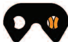
Malla de cadenas RPV y RP con alojamiento de pernos en "cuarto creciente"
