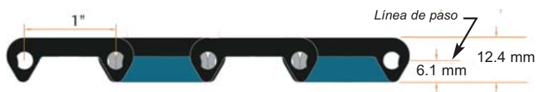
Ejecución perno doble
