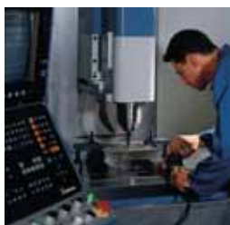
Attraverso moderne macchine operatrici a controllo numerico, vengono realizzati tutti gli stampi necessari alla produzione dei prodotti.
