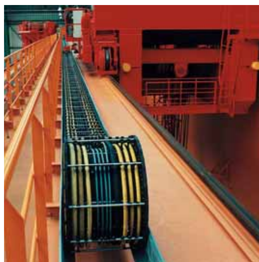
Catena tipo 318 per corse lunghe installata su carroponte.
